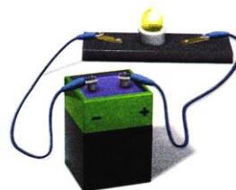
FIGURE 11 > Un circuit simple formé d'une pile et d'une ampoule
