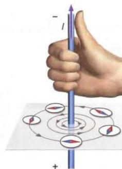
**Figure 28** | La première règle de la main droite permet de connaître le sens des lignes de champ magnétique créées par un courant qui circule dans un fil rectiligne.
