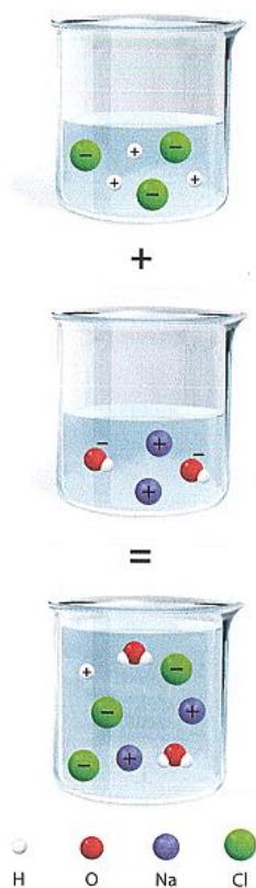
FIGURE 3 > La neutralisation incomplète de HCl par NaOH: surplus d'ions H^+ par rapport aux ions OH^- (pH < 7, donc acide)
