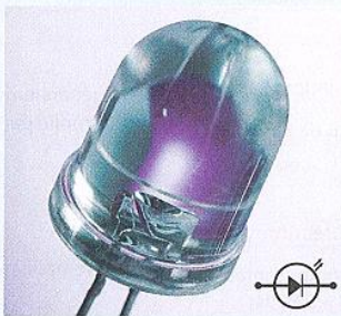
Une diode électroluminescente et le symbole normalisé qui la représente
