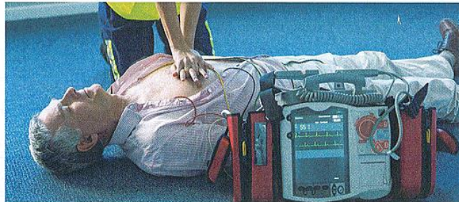
FIGURE 2 > Dans les cas de crise cardiaque, les ambulanciers utilisent un défibrillateur portable alimenté par une batterie pour faire passer un courant intense à travers la cage thoracique de la victime. Comme le rythme auquel les charges doivent être débitées est beaucoup plus grand que celui que la batterie peut fournir, le défibrillateur est muni de condensateurs.
