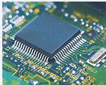
Un microprocesseur. Ses circuits comptent des millions de transistors.
